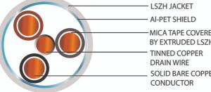
MICA TAPE COVERED BY EXTRUDED LSZH SOLID BARE COPPER
